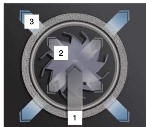
**Una soluzione pulita!** L'aria carica di grassi, odori e sostanze in sospensione viene aspirata dalla ruota del ventilatore **(1)**. Questa fa passare l'aria carica attraverso la resistenza direttamente nel catalizzatore. **(2)**. Tutti i residui vengono trasformati in acqua e anidride carbonica. L'aria pulita viene ricondotta nel forno. **(3)**. In questo modo non vi sono depositi sulle pareti interne del forno e non necessita una pulizia impegnativa.
