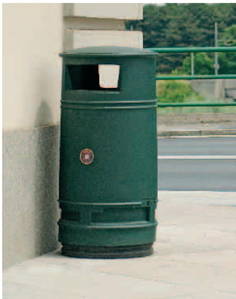
Il cestino CORTE REALE - C è costituito da una struttura in polietilene Ø 485 mm e altezza 990 mm. dotata di corpo sfilabile con apertura a baionetta e chiusura a scatto con chiave triangolare, cestino interno in acciaio zincato sp. 15/10 mm con maniglie per lo svuotamento, contenitore inferiore per zavorra, fissaggio a terra con tre tasselli ad espansione. A richiesta e con sovrapprezzo il contenitore può essere dotato di logo colorato. Peso 28 kg.
