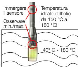
Immergere la sonda tra i segni min. e max. Osservare min./max.
