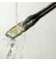
Pulire il sensore con un detergente liquido non aggressivo. Far asciugare il sensore dopo averlo pulito con una salvietta di carta.
