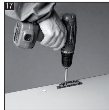
**Avvitare le basette (Q) alle estremità dell'anta utilizzando le viti (E) /** Avvitare le basette (Q) alle estremità dell'anta utilizzando le viti (E) / Avvitare le basette (Q) alle estremità dell'anta utilizzando le viti (E) / Avvitare le basette (Q) alle estremità dell'anta utilizzando le viti (E).
