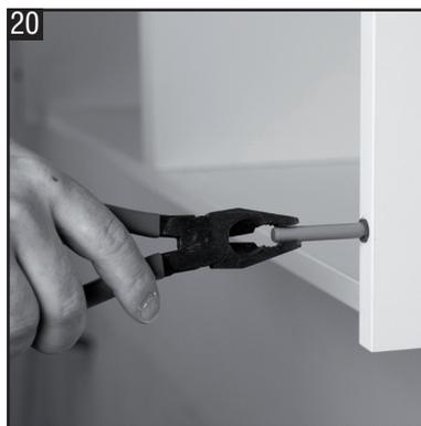
**Rimuovere i vecchi pistoncini ammortizzanti dai fianchi / Rimuovere i vecchi pistoncini ammortizzanti dai fianchi / Rimuovere i vecchi pistoncini ammortizzanti dai fianchi / Rimuovere i vecchi pistoncini ammortizzanti dai fianchi**
